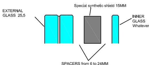
LUXSHIELD è il primo vetro blindato con uno speciale tipo di materiale polimerico come lastra centrale di una vetrocamera tripla. I vantaggi di questa soluzione sono:
